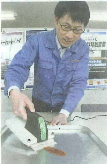
ゾルやゲル状のワークを形崩れせずすくいい取り、移動できる古川機工のスイットル
